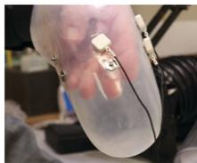
5. Far scattare le schede degli elettrodi sul sostegno della cupola dell'elettrodo e accertarsi che siano collegate in maniera stabile. La posizione degli elettrodi può sempre essere modificata in seguito secondo necessità.
