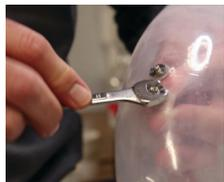
3. Mettere il dado snap sul sostegno della cupola dell'elettrodo e serrare a mano. Usare il cacciavite esagonale in dotazione (CP-HXD) per serrare a fondo.
